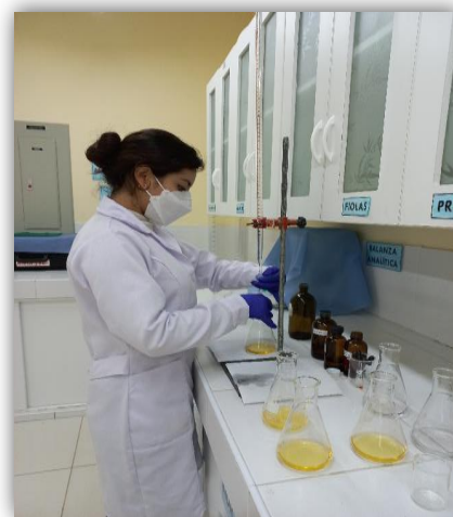
MEDICIÓN DE LA ALCALINIDAD DEL AGUA AL INGRESO Y SALIDA DE LA PTAP
