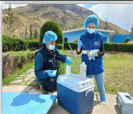
PUNTO DE MUESTREO PTAP MILLPO, PARA EVALUACIÓN DE LA CALIDAD DEL AGUA PRODUCIDA Y EVALUADA POR LABORATORIO ACREDITADO
