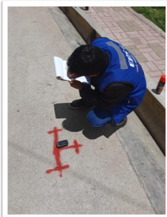
Toma de datos en campo (coordenadas UTM, identificación de los accesorios que pasan por la Red Matriz)
