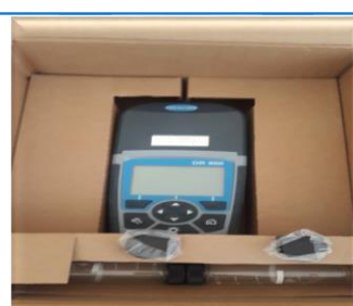
EQUIPO DE ANALISIS DE CLORO RESIDUAL
