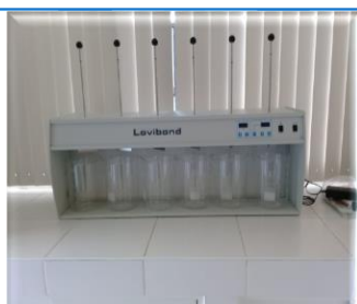
ADQUISICION DE EQUIPOS DE PRUBAS DE JARRAS
