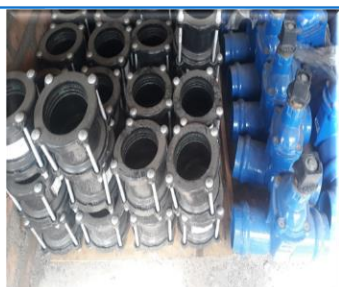
ADQUISICION DE UNION FLEXIBLE Y VALVULAS
